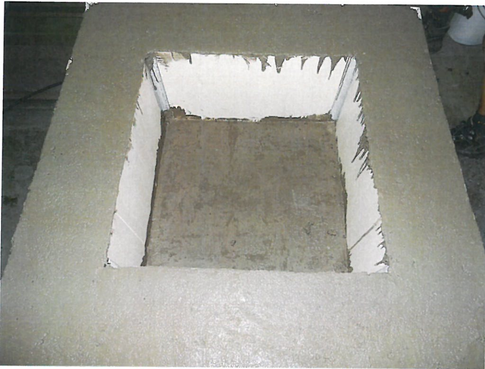
Bild 9 Prüfkörper nach Betonieren des Rahmens
